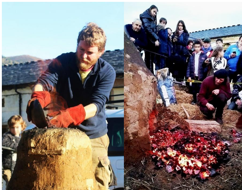
Fig. 5. Horno de reducción de hierro de Taramundi (2018). Izquierda: carga del horno. Derecha: apertura del horno.
