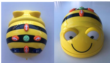
Figura 1. Robot de suelo Bee-bot con panel de programación en la parte superior
